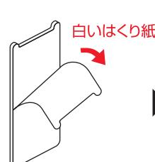
「吸着補助シート(白)」あるいは（黒）の裏面の白いはくり紙を剥がします。固定したい面にしっかりと貼り付けます。
