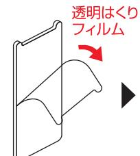
貼り付けた後、表面の透明はくりフィルムを剥がします。
